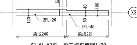
X3-Y1-Y2梁 梁天端平面図1/20
