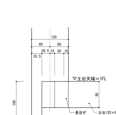
X3-Y1, X4Y1柱脚部詳細1/3
