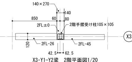
X3-Y1-Y2梁 2階平面図1/20
