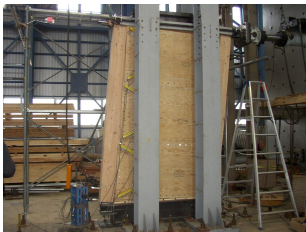
写真-11 耐震壁耐力実験
