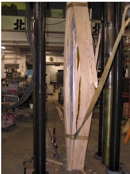
写真-9 柱座屈実験
