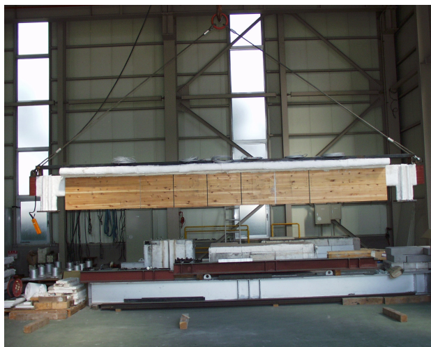
写真-5 一本の梁に6本の目地を設け6種類の目地材を入れた
