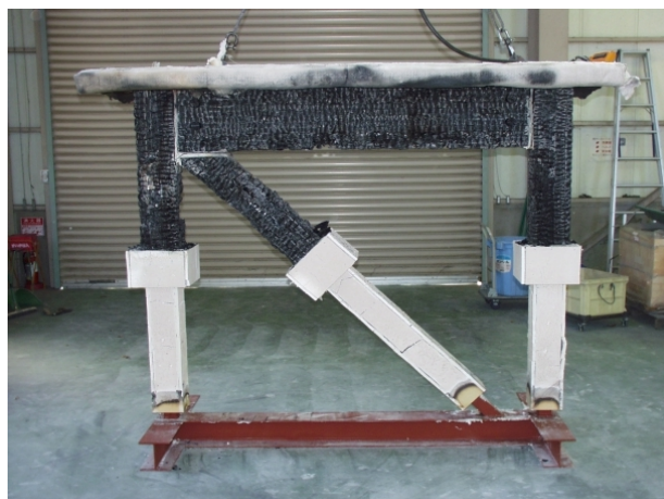
写真-7 仕口部の耐火実験後(耐震壁は燃え尽きている)
